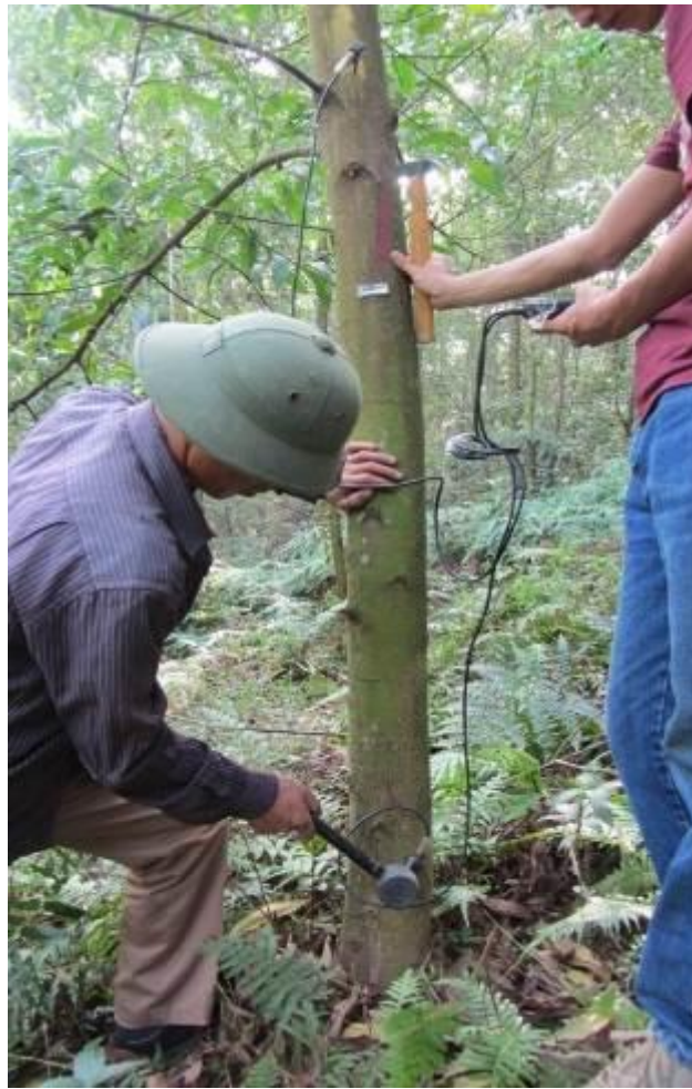
Hình 2.4. Thu số liệu Fakopp tại khảo nghiệm giống lai Ba Vì
