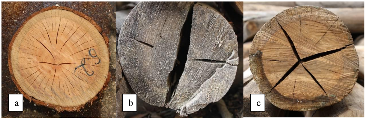
Hình 3. Nứt tâm trên mặt đầu khúc gỗ tròn Bạch đàn trắng để ngoài trời
